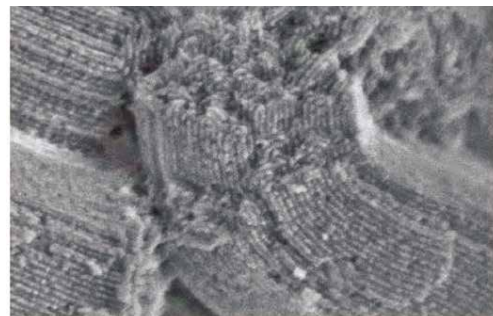
Мезопористый оксид кремния. Ускоряющее напряжение: 1 кВ. Увеличение: 150 000х.
