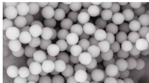
Микросферы диоксида кремния. Ускоряющее напряжение: 10 кВ. Увеличение: 80 000x.
